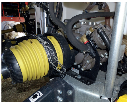
AGP 1000 PRO ima vgrajeno črpalko APS 121 S italijanskega proizvajalca COMET. Zmogljivost črpalke je 115 l/min pri 50 bar.
