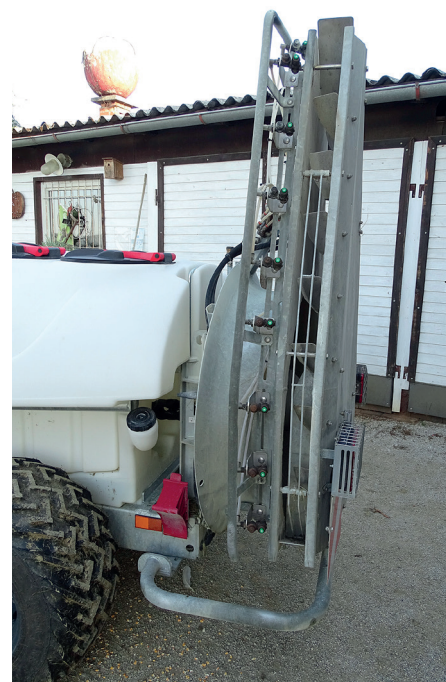
Usmernik je visok 170 cm. Vidne so usmerjevalne lopute, ki zagotavljajo ustrezno smer zračnega toka in s tem tudi škropiva.
