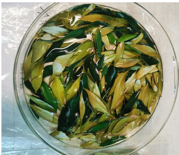
Slika 2: 200 listov namočenih v 5% NaOH (Hoblaj)
