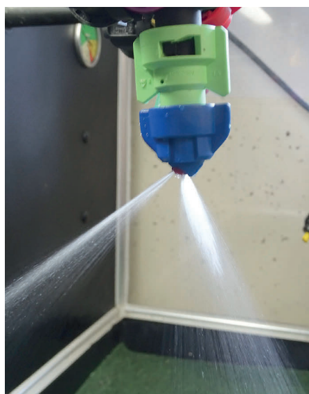
Delovanje Agrotop TurboDrop® VR z variabilnim pretokom in asimetričnim dvojnimi ploščatim curkom
