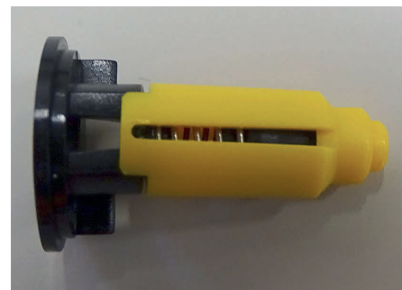
Agrotop TurboDrop® VR šoba ima v injektorskem vložku vgrajen obhodni ventil, ki pri spremembi tlaka škropljenja spreminja prečni presek odprtine in s tem tudi volumnski pretok šobe.
