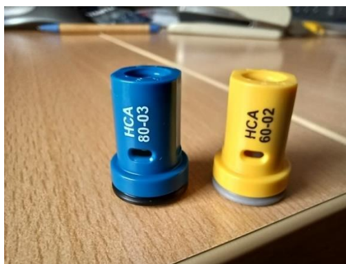
Slika 3: Dve ASJ šobi, modra ima škropilni kot 80 stopinj, rumena pa 60 stopinj. Modra ima velikostno oznako 03, kar pomeni 0,3 galone/min pretoka, rumena pa ima oznako velikosti 02, kar pomeni 0,2 galone/min. Obe šobi sta tudi barvno kodirani po ISO standardu. HCA je ime serije šob.
