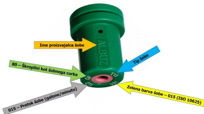
Slika 1: Označevanje šobe (vir: Temeljna načela dobre kmetijske prakse varstva rastlin in varne rabe fitofarmacevtskih sredstev).
