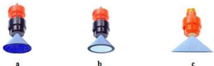
Slika 13: Glavni tipi šob in njihove oblike curkov: a – šoba s stožčastim polnim curkom, b – šoba s stožčastim votlim curkom, c – šoba s ploščatim curkom (vir: V. Jejčič).
