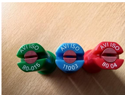
Slika 4: Albuz AVI šobe, barvno kodirane in tudi številčno označena velikost (pretok) šobe ter škropilni kot.
