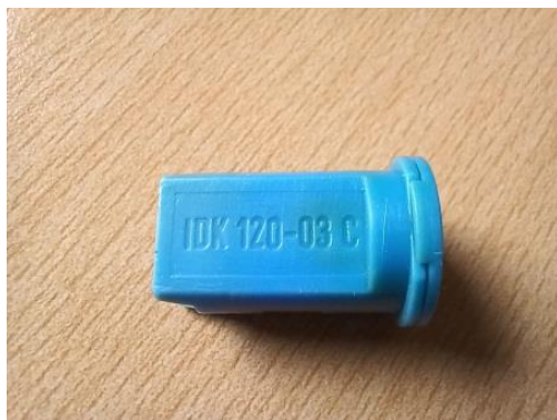
Slika 2: Lechlerjeva oznaka na šobi pomeni: IDK - ime serije šob, 120 - škropilni kot šobe, 03 - oznaka velikosti šobe oziroma oznaka pretoka šobe (0,3 galone/min), C - material šobe (C je oznaka za keramiko), barvno kodiranje - modra barva ravno tako označuje pretok šobe oziroma velikost šobe.
