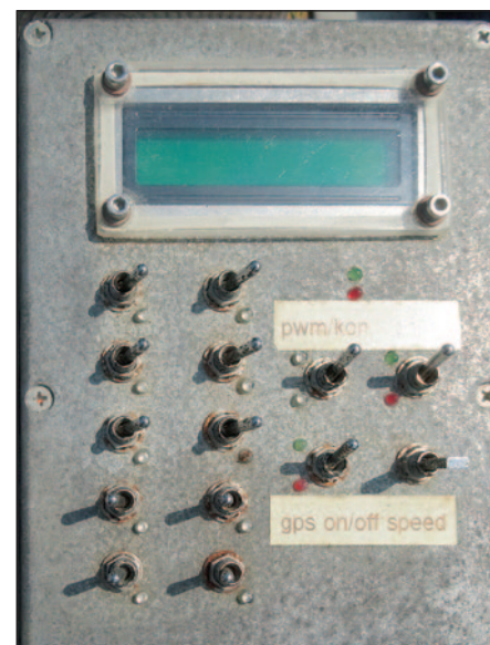
Krmilna konzola za aktiviranje PWM sistema je nameščena v traktorski kabini (uporabnik pršilnika določi način delovanja).
