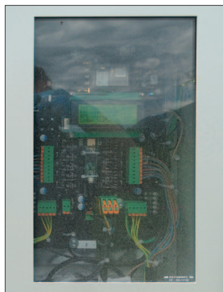
Mini računalnik na osnovi posnetkov laserskega skenerja s posebnim programom optimizira PWM krmiljenja škropilne brozge glede na pojav in gostoto listne mase vinske trte.
