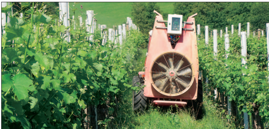
Pršilnik standardne izvedbe nadgrajen s slovenskim sistemom za ciljno nanašanje škropiva s PWM sistemom na osnovi LIDAR kamere
