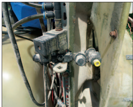
Elektromagnetni ventil, ki pulzno odpira in zapira pretok škropiva skozi šobo na pršilniku.
