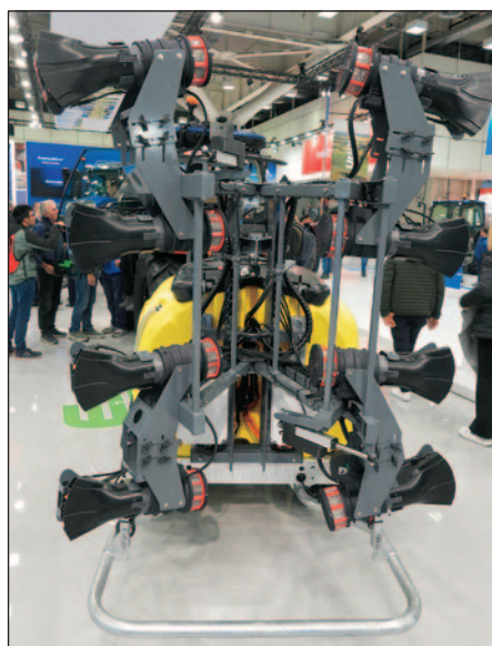
Caffini Zephro pršilnik z osmimi električnimi ventilatorji, PWM šobami in stereo globinsko kamero.
