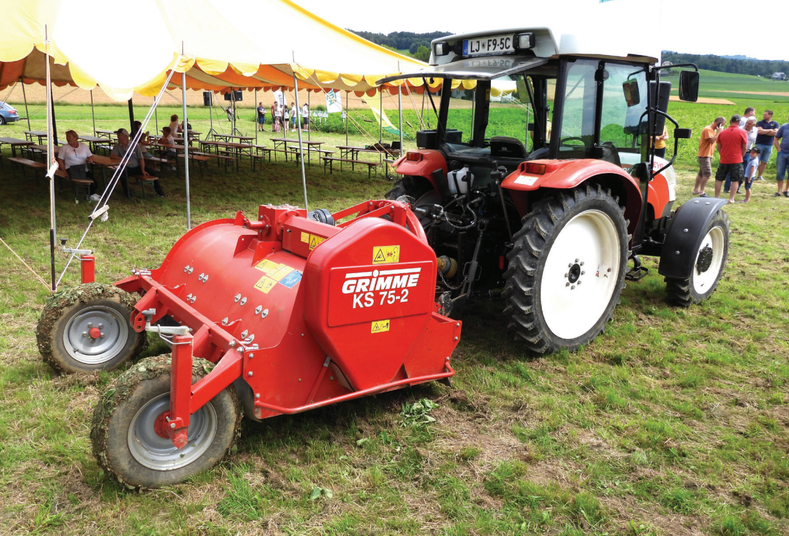
Grimme KS 75-2 ima dve po višini nastavljivi pnevmatiki, s katerimi nastavljamo globino dela.
