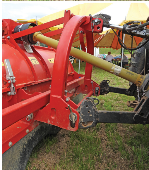
Grimme KS 75-2 ima dve po višini nastavljivi pnevmatiki, s katerimi nastavljamo globino dela.
