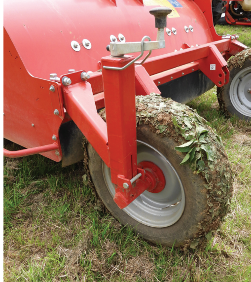
Grimme KS 75-2 ima dve po višini nastavljivi pnevmatiki, s katerimi nastavljamo globino dela.
