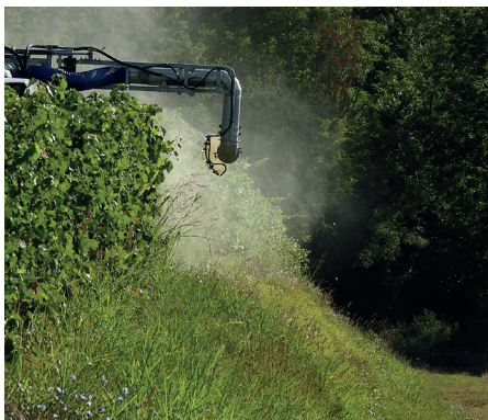
Pršilnik omogoča z zgornjim usmerjevalnikom kakovostno škropljenje zunanje stene v robni vrsti na terasi.
