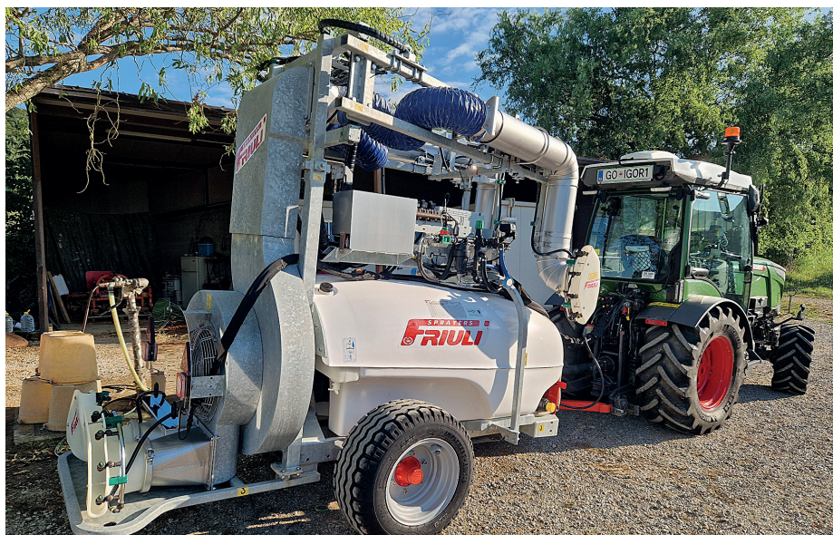
Vlečeni pršilnik Compact Twin 1000 ima rezervoar s prostornino 1090 litrov (nazivna prostornina pa je 1000 litrov), radialni ventilator in štiri usmerjevalnike zračnega toka, ki omogočajo obojestransko škropljenje dveh vrst vinske trte.
