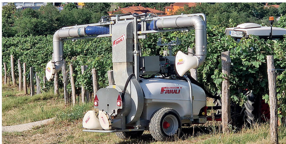
Pršilnik Friuli Sprayers Compact Twin 1000 s štirimi usmerjevalniki zračnega toka za škropljenje štirih sten vinske trte.
