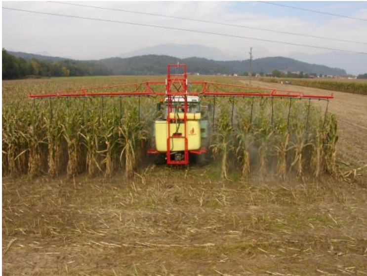
Slika 7: Škropilnica z visoko nameščenimi letvami in cevni podaljški (Foto: Š. Modic)
