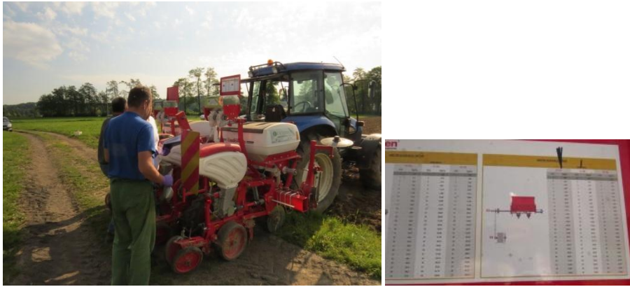
Sliki 5 in 6: Sejalnica z dozirno napravo za trosenje insekticidnih granulotov, opremljena z nastavitveno shemo (foto I. Škerbot)
