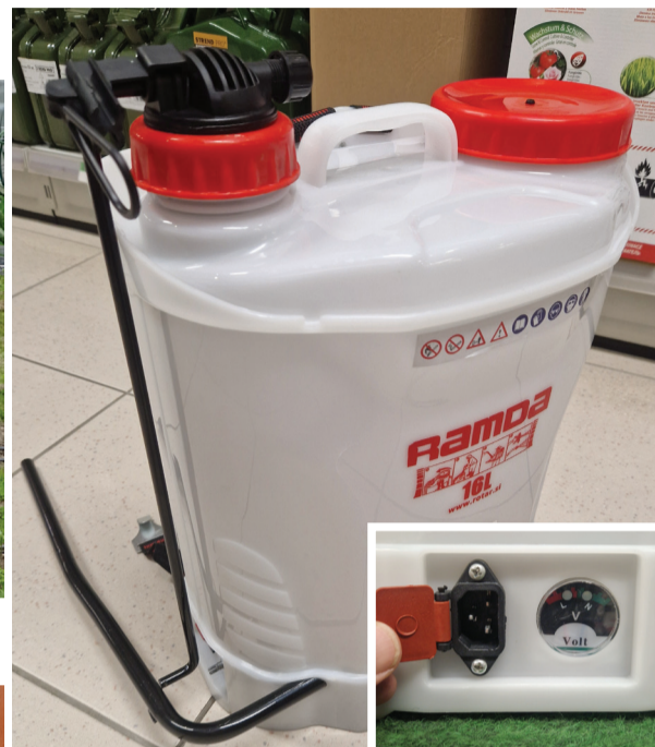
Ramda 2-v-1 je ročna in električna nahrtna škropilnica. Gre za električno (baterijsko) in ročno škropilnico v eni napravi. Ročno škropljenje je možno, ko je baterija skoraj prazna.
