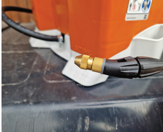
Šoba je bistveni del nahrbtnne škropilnice, pogosto je nastavljiva.
