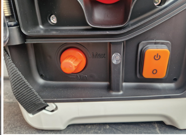
Pri baterijskih nahrbtnnih škropilnicah imamo dve stikali. Eno je za vklop in izklop škropilnice. Drugi gumb – vrtljivi regulator pa služi za nastavljanje delovnega tlaka in količine sredstva za zaščito rastlin.
