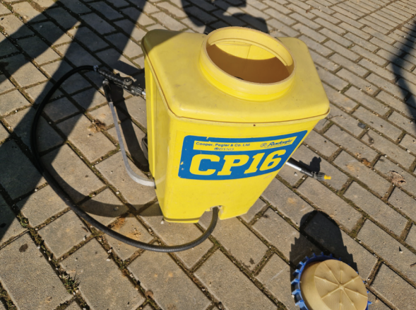
Nahrtna škropilnica z membransko črpalko Cooper & Pegler CP16. Primerna je za nizke tlake in za herbicide.
