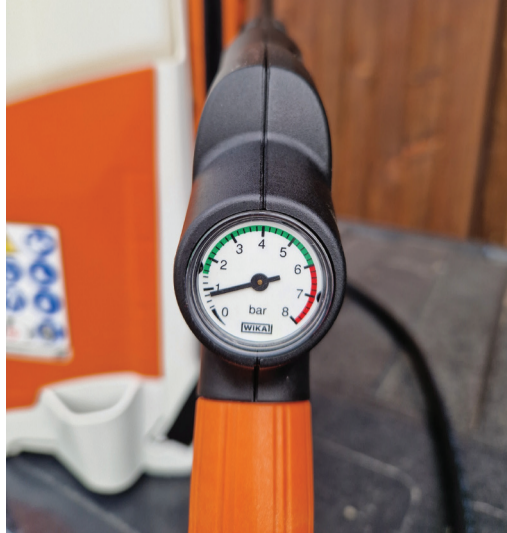
Manometer na škropilni palici nahrbtnne škropilnice Stihl, kjer je označeno zeleno in rdeče območje tlaka (ustrezen delovni tlak in tlak, ki je previsok).
