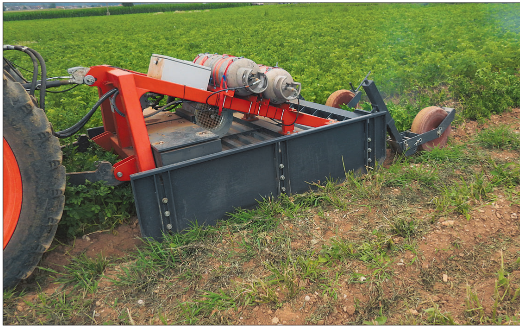
HOAF KB 1,5 Twin je naprava za termično zatiranje plevelov in uničevanje krompirjevke z delovno širino 1,5 metra.
