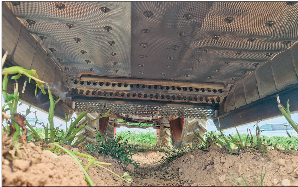
Pogled na napravo HOAF od spodaj proti traktorju. Spredaj sta dva prečna niza gorilnikov, preostala spodnja površina pa deluje kot infrardeča sevalna plošča.
