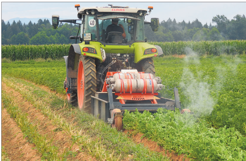
HOAF med delom. Takoj po prehodu je krompirjevka videti le poležana, znaki toplotne poškodbe in osušitve pa postanejo vidni šele pozneje.
