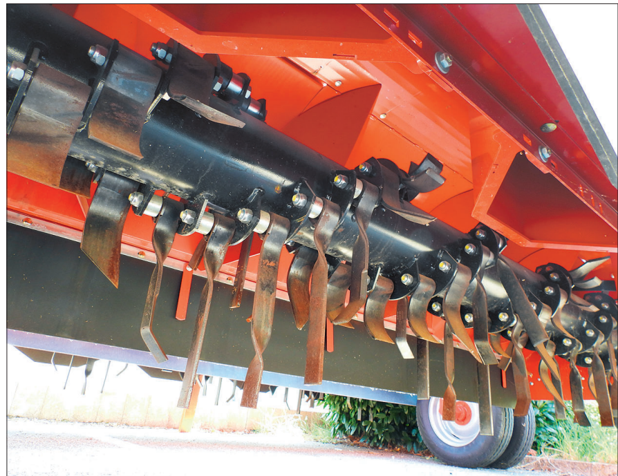
Delovni elementi – kladiiva (noži) – so različnih oblik in dolžin, kar omogoča prilagajanje profilu krompirjevih grebenov.
