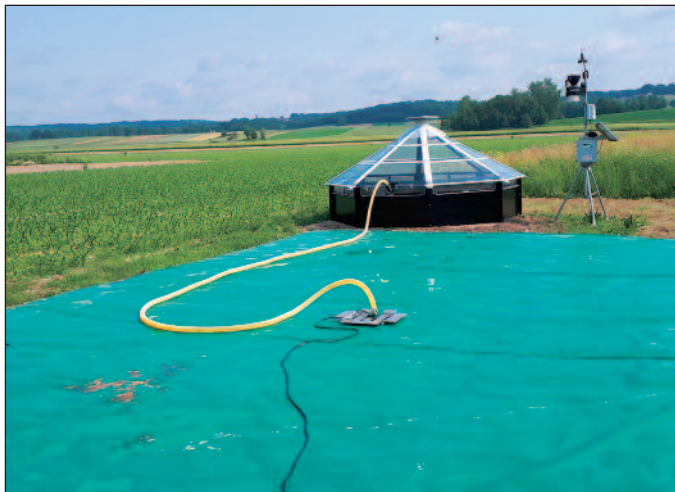
Syngentin sistem RemDry uporablja fizikalen način odstranjevanja vode (izhlapevanje) iz zbrane pralne (kontaminirane) vode po čiščenju naprave. Vir slike: Syngenta
