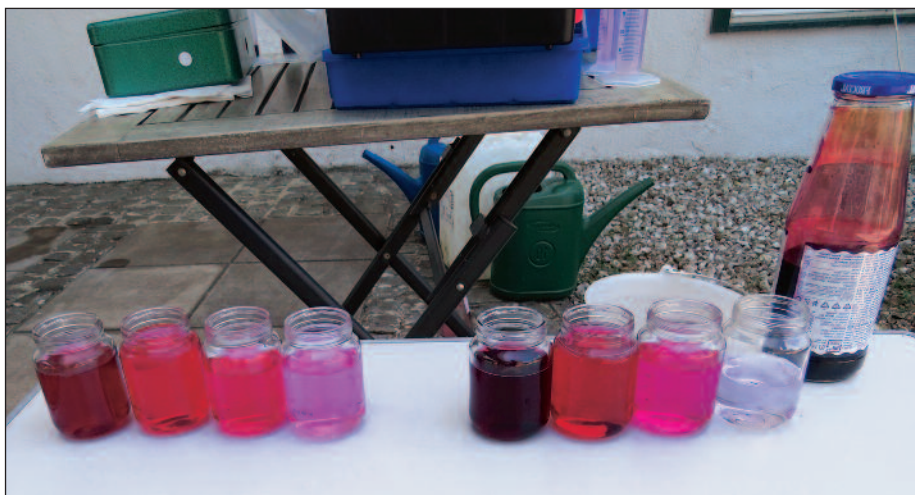
Prikaz učinkovitosti delovanja čistilnih sistemov. Leva skupina kozarčkov prikazuje »čistost« škropilnice oziroma »pralne vode« po trikratnem čiščenju rezervoarja na klasičen način. Desna skupina kozarcev pa prikazuje čistost iztočene tekočine na šobah med pranjem rezervoarja na kontinuirani način. Na začetku je bil preostanek vode v rezervoarju škropilnice obarvan s sokom rdeče pese.
