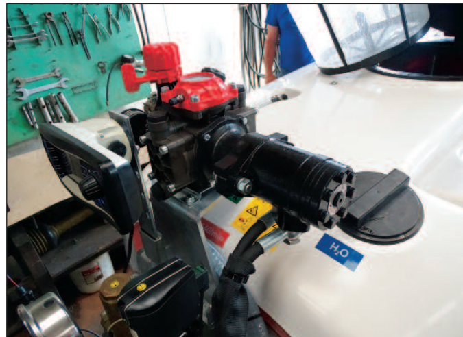
Dotatna črpalka s pogonom na hidromotor za kontinuirano notranje pranje rezervoarja pri Zupanovem vlečenem pršilniku iz serije DT, ki je opravil tudi test pri nemškem inštitutu JKI in ima deklarirano 95 % zmanjšanje zanašanja škropiva – drifta.
