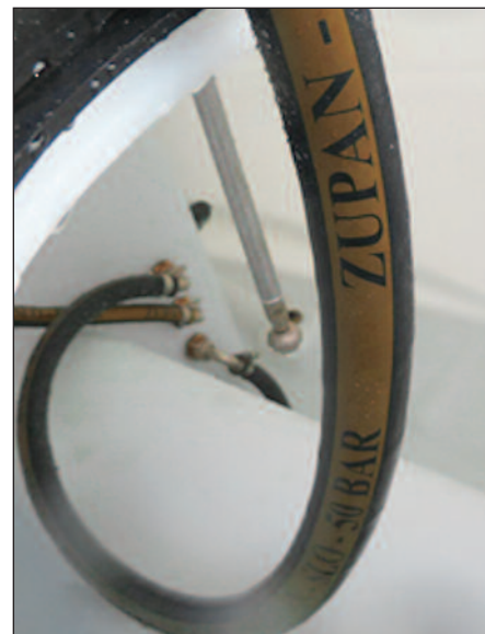
Zupan ima v vlečenih pršilnikih nameščeni dve čistilni šobi za kontinuirano čiščenje. Šobi morata biti nameščeni tako, da omogočata popolno čiščenje celotne notranjosti rezervoarja.
