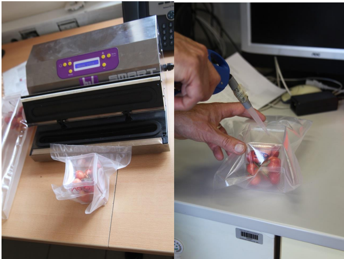
Slika 2: Po 30 g naključno izbranih plodov, ki so bili izpostavljeni PVM, smo dali v PVC vrečko in z varilnikom dobro zatesnili, da smo zagotovili dovolj visoko vlago in omogočili spreminjanje atmosfere (levo). Vrečka s plodovi, med postopkom spreminjanja atmosfere znotraj PVC vrečke (desno).
