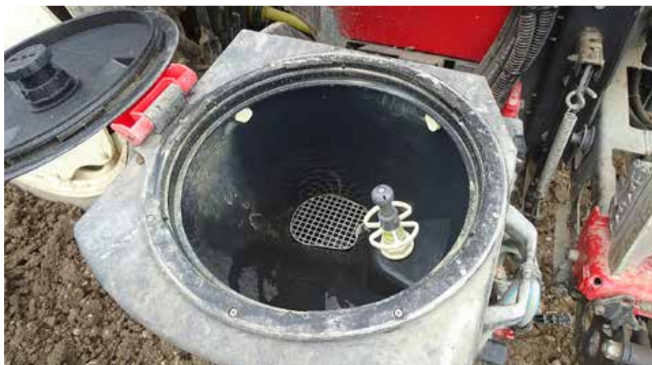
Polnilna posoda z ventilom za pranje embalaže je pregibne izvede. V času uporabe jo spustimo nižje in tako brez težav polnimo škropilnico s fitofarmaceutskimi sredstvi.
