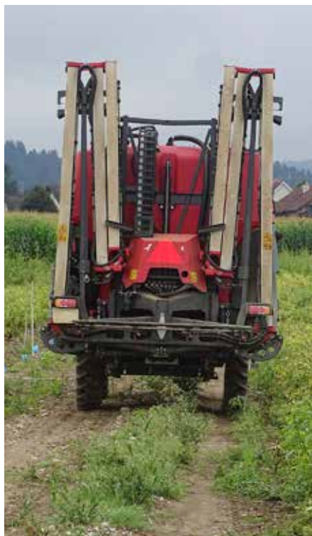
Transportni položaj škroplilnice z vertikalno zloženimi škroplilnimi letvami.
