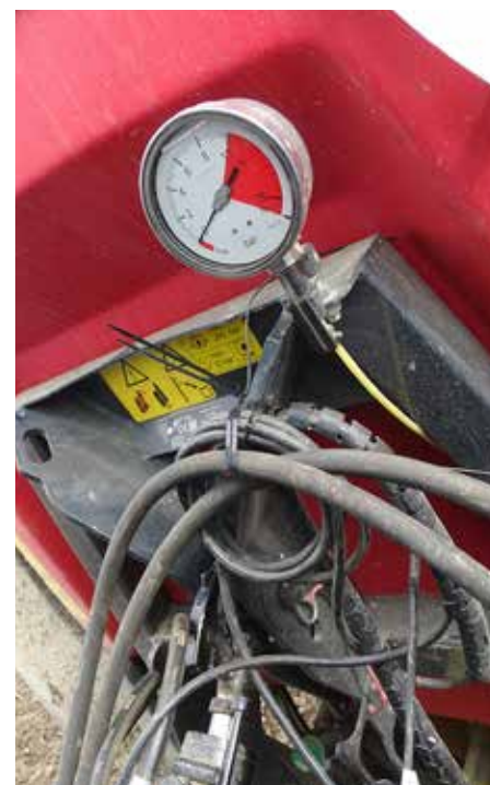
Na sprednjem delu škropilnice je nameščen velik in dobro viden manometer
