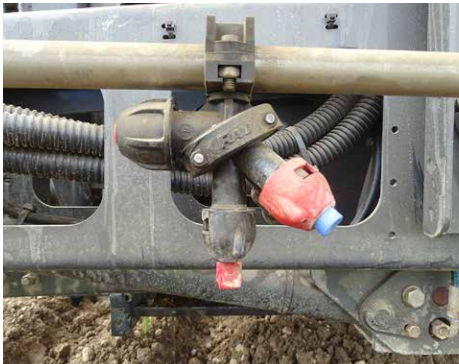
Na škropilnih letvah so nameščeni trojni nosilci za šobe. Tu se vidi še napis RAU, ki ga je Kverneland pred leti prevzel pod svoje okrilje.
