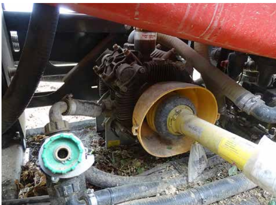
Batno membranska črpalka s pretokom 200 l/min.
