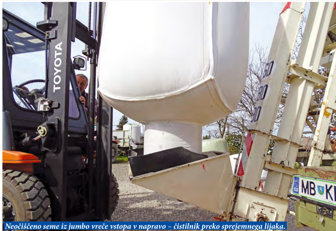
Mobilna naprava za dodelavo žita s čistilnikom žita in napravo za tretiranje semena.
