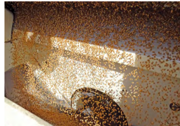
Neočiščeno seme iz jumbo vreče vstopa v napravo – čistilnik preko sprejemnega lijaka.
