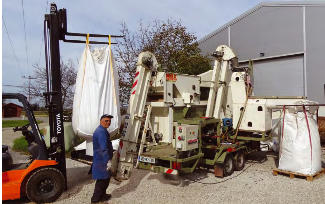
Mobilna naprava za dodelavo žita s čistilnikom žita in napravo za tretiranje semena.
